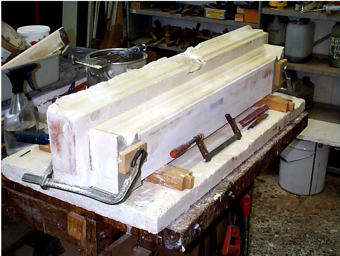
hetzelfde onderdeel waarvan de onderste lijst is bijgewerkt met gips
