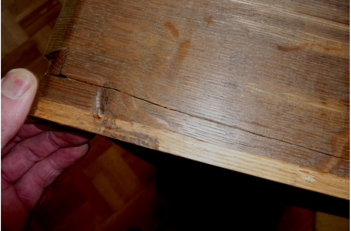
Boven : gescheurde zijkant van een der lades. Onder: vlekken t.g.v. vocht op het bovenblad
